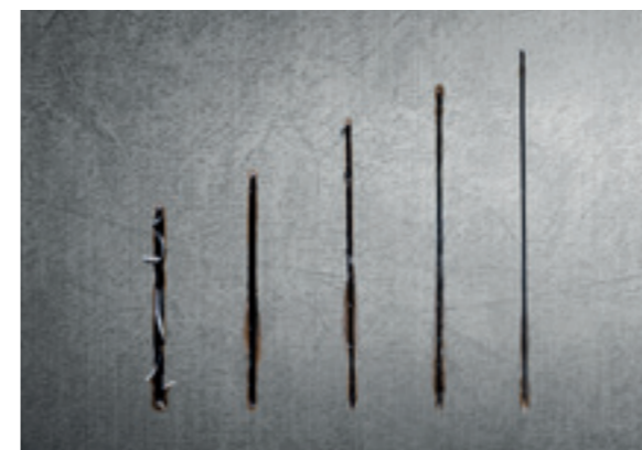
Evolutie van het doorslijpen: braamarm met koele snede
